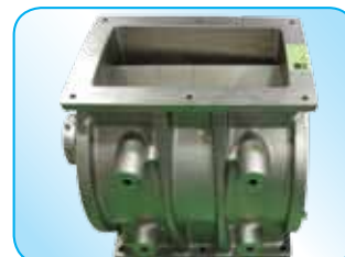
Completamente nichelata Usata per prodotti corrosivi o, quando accettata, in sostituzione dell'Acciaio Inox per applicazioni con prodotti alimentari. Anche il rotore e la flangia laterale sono completamente nichelati
